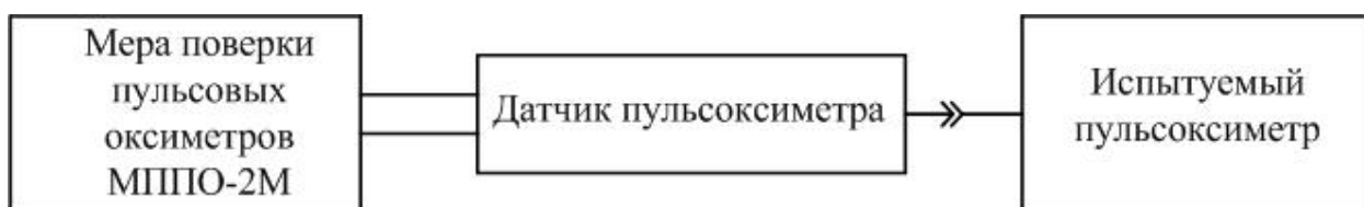
Рисунок 4.1 – Схема проверки точности измерений, диапазона измерений и диапазона индикации ЧП и уровня SpO_2
