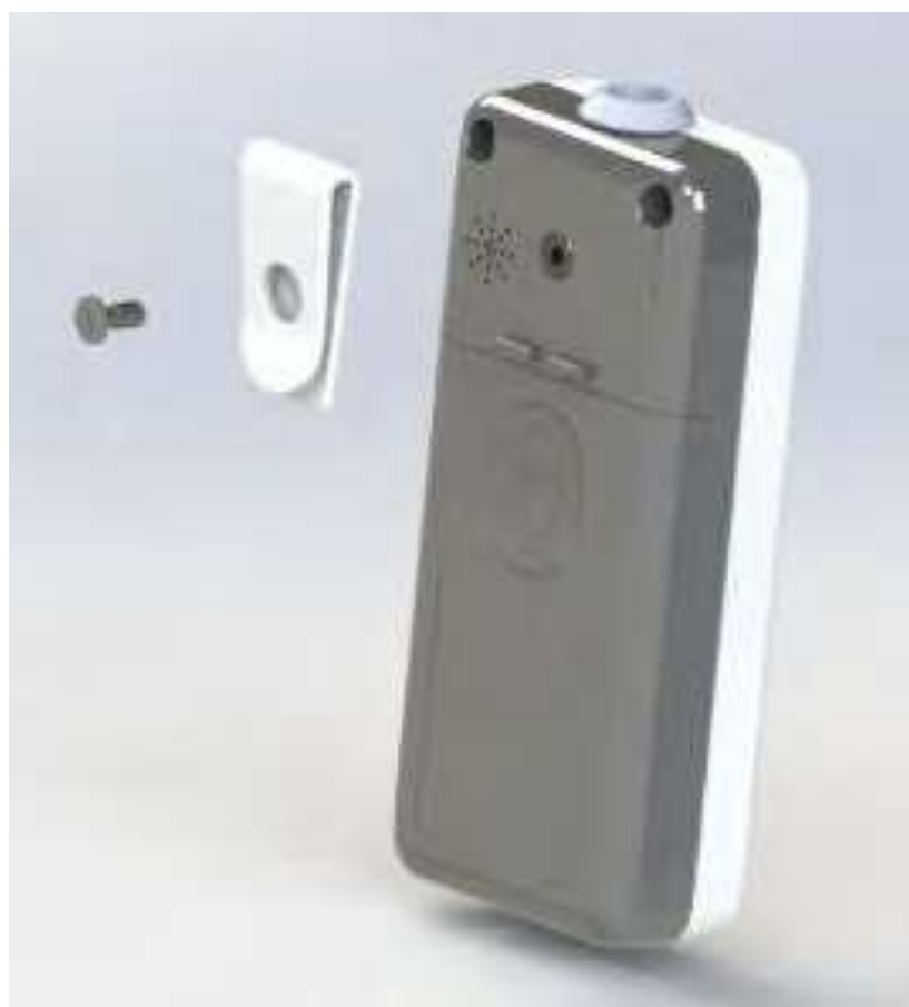
Рисунок 2.8 – Крепление кронштейна к пульсоксиметру
